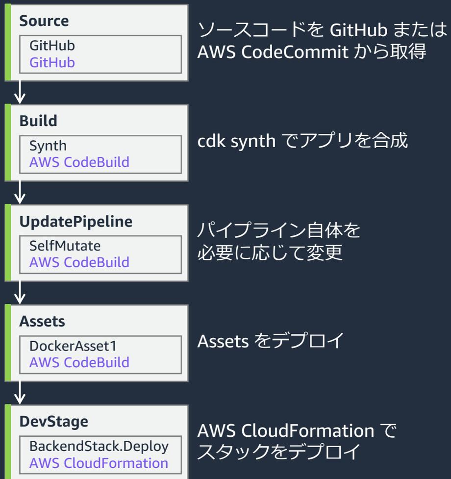
AWS CodePipeline を使った CDK アプリの CI/CD パイプラインを簡単にセットアップできるコンストラクトライブラリ
