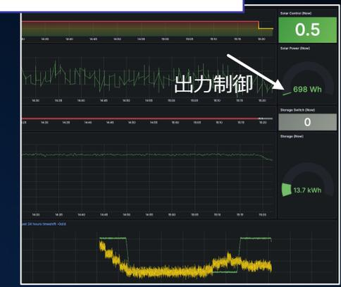
VPPの実現に必要な、再エネなどのIoT設備との連携(データ連携、制御)や外部情報(天候・電力市場)の連携、**予測(再エネ発電量、電力市場)**や**大量データの可視化・分析**の機能を**AWSのマネージドサービス**をフル活用して実現
